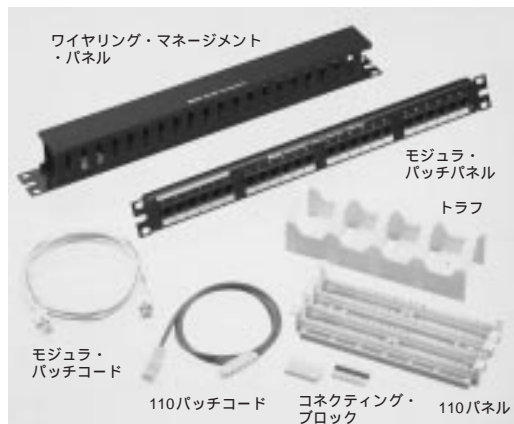
写真1 パッチパネルとパッチコード 二つの製品グループがある。片方は、ワイヤリング・マネージメント・パネル(WMP)、モジュラ・パッチパネル、モジュラ・パッチコードを組み合わせて使う。もう一方は、トラフ、110パネル、コネクティング・ブロック、110パッチコードを組み合わせて使う。WMP、トラフはパッチコードの余りを収容する。コネクティング・ブロックは、110パネルにケーブルを成端する機器。
