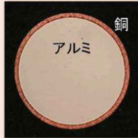
＜第4図＞10D-SFAの中心導体断面
